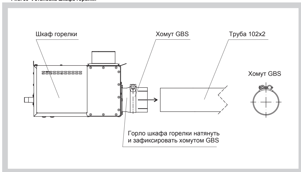
Рис. 39 Установка шкафа горелки
