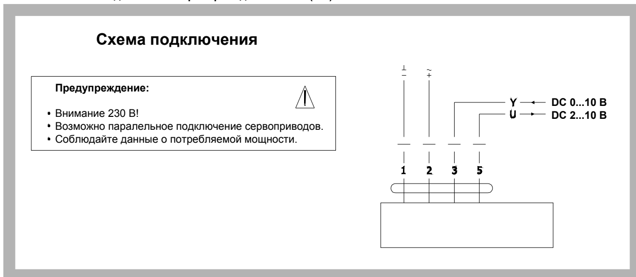
Рис. 10. Схема подключения сервопривода Velimo LM(NM) 24A-SR
